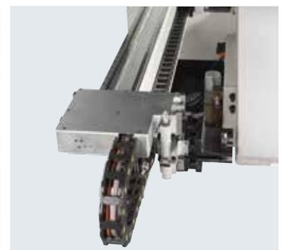
Le due guide e i motori Brushless uniti al sistema pignone-cremagliera offrono precisione e velocità di posizionamento.
