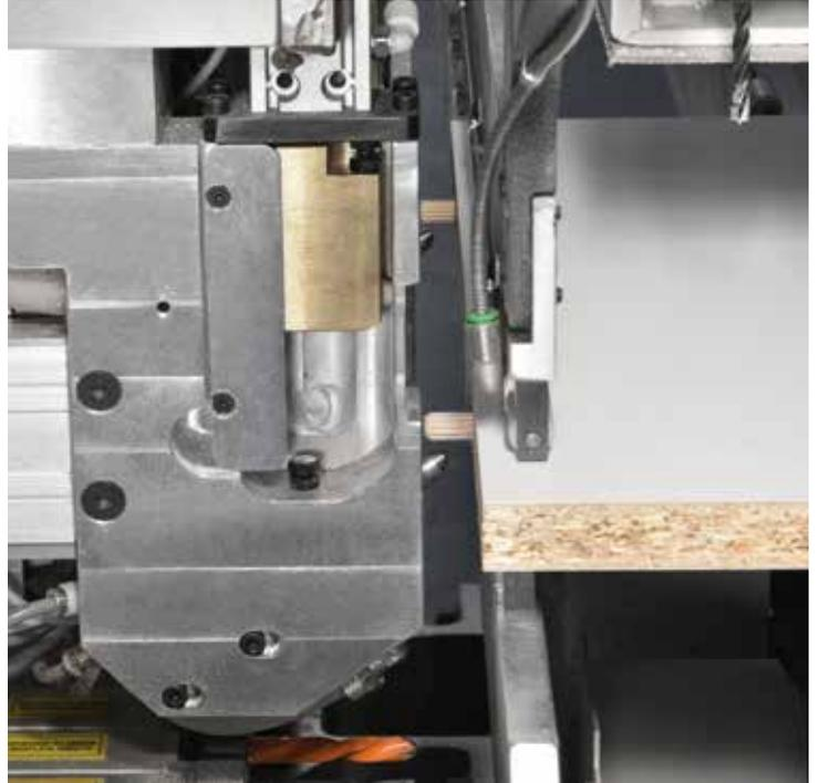
L'alimentazione continua delle spine avviene tramite un vibratore elettromeccanico. Il gruppo può essere dotato dell'impianto per la colla vinilica o per l'acqua se si utilizzano spine pre-collate.
