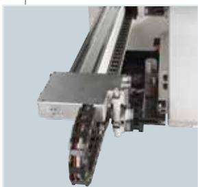
**Le due guide e i motori Brushless** uniti al cinematismo pignone-cremagliera, offrono **rigidità di spostamento unita a precisione e velocità di posizionamento**.
