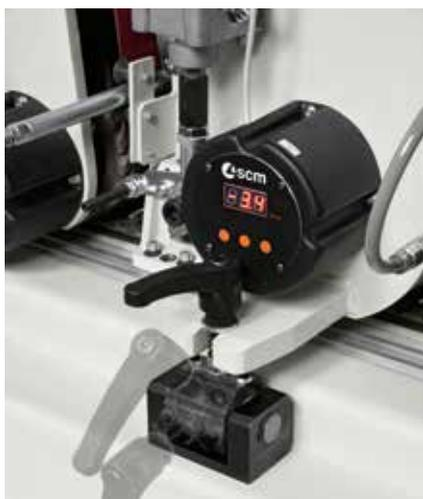
Il **sistema di bloccaggio rapido** dei gruppi al basamento ed il visualizzatore digitale della quota di lavoro rendono l'operazione di **sostituzione del nastro abrasivo ed il settaggio della macchina estremamente veloce e precisa**.
