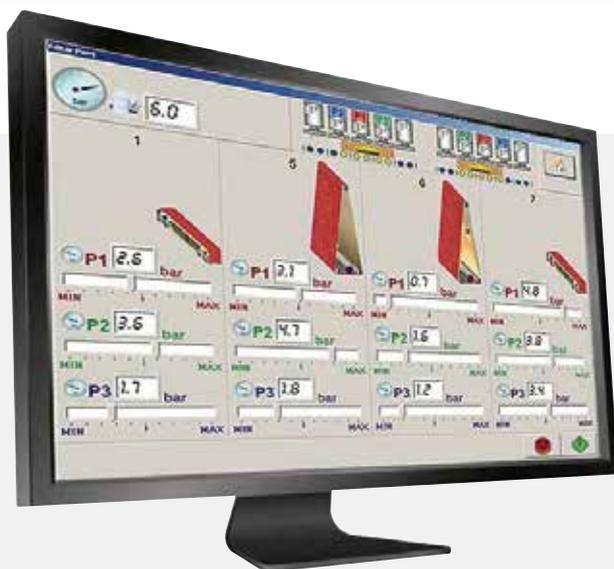
Il sistema "PWM" è totalmente gestito dal controllo elettronico "MAESTRO PRO-SAND". Grazie all'avanzata interfaccia operatore, appositamente sviluppata da SCM, è possibile visualizzare e settare tutti i parametri di intervento del dispositivo e salvarli nei singoli programmi.
