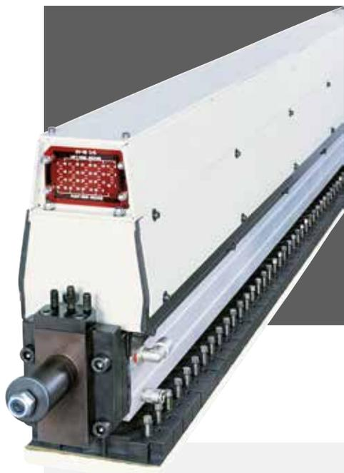
Il pattino sezionato "EPICS" è costituito da una speciale traversa monolitica all'interno della quale sono alloggiati i cilindri di attivazione dei singoli settori. Grazie all'ampia escursione dei pistoncini ed al sistema a doppio effetto (spinta e controspinta pneumatiche regolabili), il pattino "EPICS" garantisce la **massima sensibilità e precisione** in qualsiasi tipo di lavorazione.
