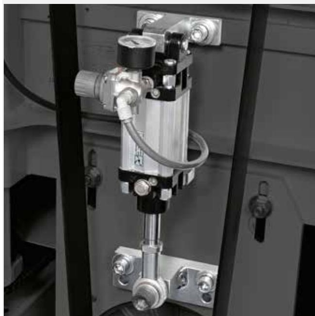
I gruppi rullo sono dotati di un sistema di autotensionamento della cinghia che permette di mantenere costante nel tempo il corretto tensionamento e garantisce la massima efficienza di trasmissione della potenza del motore.
