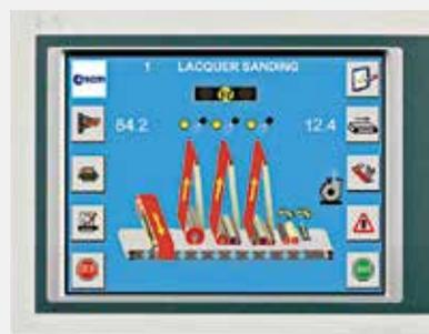
Il controllo "**PRO-SAND**" permette di impostare da touch screen tutti i parametri di lavorazione e di **verificare in tempo reale il corretto funzionamento** della macchina.
