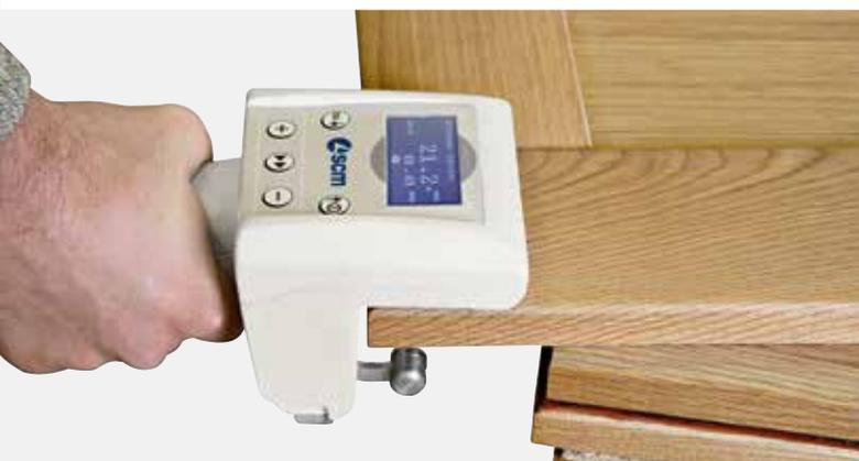
Il **calibro elettronico wireless** consente di posizionare la macchina allo spessore di lavoro misurato dal dispositivo stesso. **La comunicazione alla macchina avviene senza fili** ed è possibile richiamare da remoto anche il programma di lavoro desiderato.
