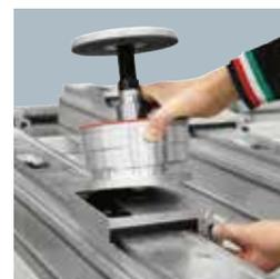
*Caricare e scaricare i pezzi in modo agevole ed ergonomico, portarli in automatico in zona di lavoro ed evitare qualsiasi tipo di collisione è possibile grazie alla **totale gestione del piano di lavoro**. La pulizia avviene tramite **sistemi di soffiaggio** che rimuovono i trucioli sia dalla zona di scorrimento che dal piano di appoggio del pezzo.*
