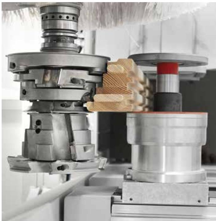
*Morsetti di bloccaggio con altezza 145 mm (H145) per lavorare con utensili a doppio profilo elementi di diverso spessore, da 60 a 120 mm, senza la necessità di set-up manuale.*
