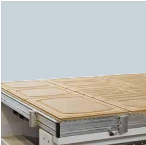
*L'impianto del vuoto è ricavato direttamente all'interno degli estrusi in alluminio e distribuito su un reticolo di canali e fori disposti a passo 120 mm su tutta la superficie del piano di lavoro.*
