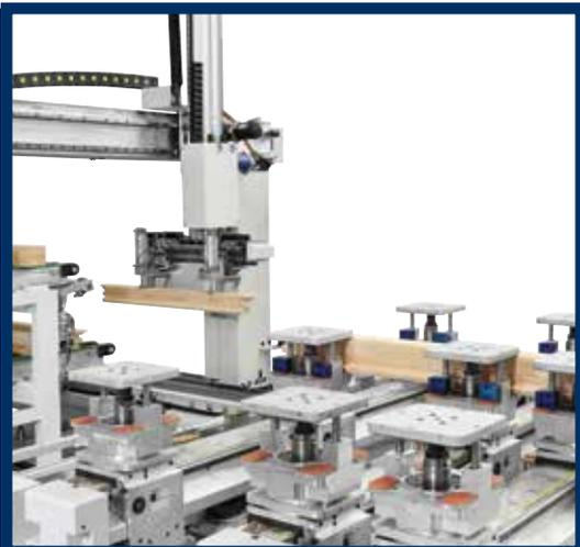
*Cella di lavoro flessibile per la produzione di serramenti e porte, dotata di sistema di carico e scarico automatico.*
