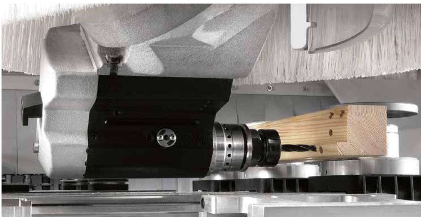
**Precisione del 5 assi garantita** con il dispositivo RTCP setting (Rotation Tool Centre Point) che ripristina automaticamente i parametri del gruppo operatore mediante un sistema di auto-taratura e una funzione disponibile da programma, sviluppati entrambi da SCM.
