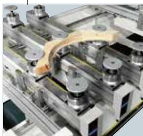
*Piano di lavoro a barre configurabile con morsetti e ventose, ideale per la lavorazione del legno massello.*
