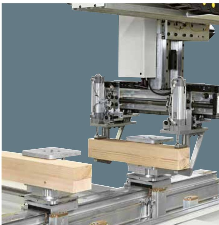
Elementi di lunghezza ridotta sono caricati in maniera automatica e bloccati su un singolo morsetto.
