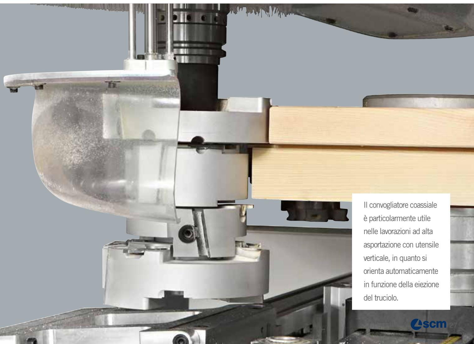
Il convogliatore coassiale è particolarmente utile nelle lavorazioni ad alta asportazione con utensile verticale, in quanto si orienta automaticamente in funzione della eiezione del truciolo.
