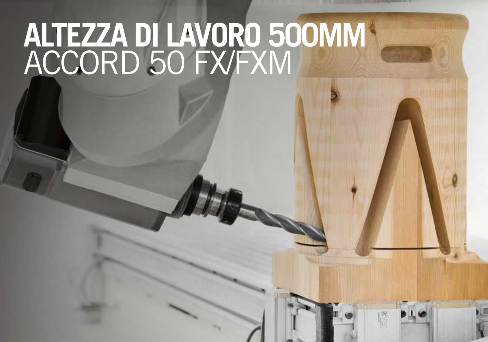
La robusta struttura della macchina e la geometria del gruppo operatore permettono all'utensile di **ruotare liberamente attorno a pezzi di forma complessa** e realizzare lavorazioni tridimensionali con elevata precisione e massima qualità di finitura.
