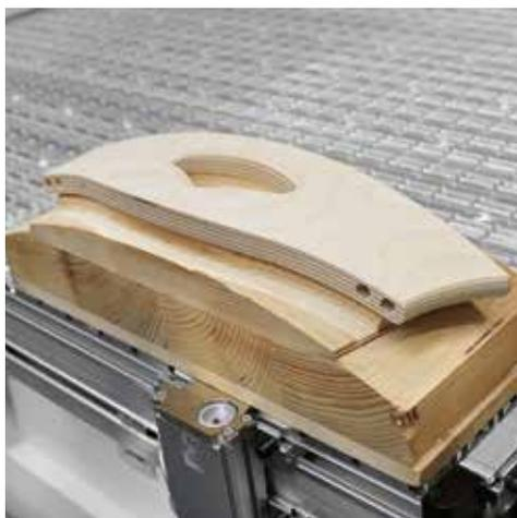
Su tutta la superficie del piano sono presenti **scanalature a T** che consentono di fissare rigidamente eventuali contro-sagome e attrezzature di fissaggio non fornite da SCM.
