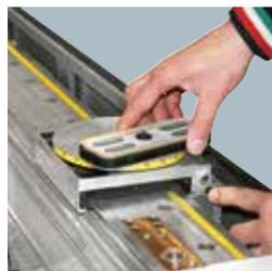
*Facile e veloce sostituzione di morsetti e ventose premendo semplicemente un pulsante, con l'esclusivo aggancio rapido.*
