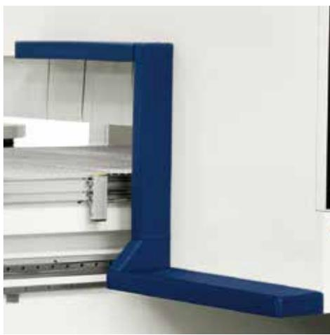
*La protezione del gruppo operatore dotata di bumper compatti permette di sfruttare tutta l'area di lavoro disponibile, posizionando più pezzi contemporaneamente sul piano.*
