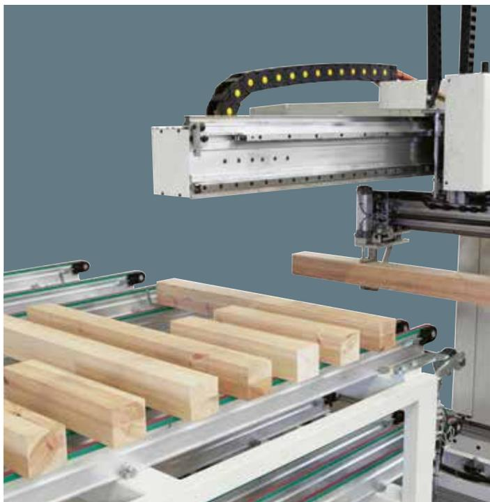
Sul buffer di carico si possono posizionare più elementi di diversa lunghezza. Il controllo dimensionale dell'elemento (lunghezza, larghezza, spessore) avviene tramite sensore ottico al momento del carico da parte dell'operatore.
