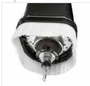
*Unità di fresatura posteriore con elettromandrino a 3/4 assi.*
