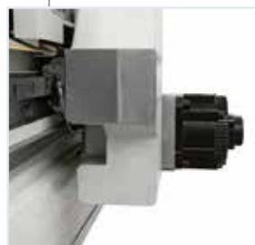
**Totale assenza di vibrazioni** anche ad alta velocità con la struttura a portale movimentata da doppio motore.
