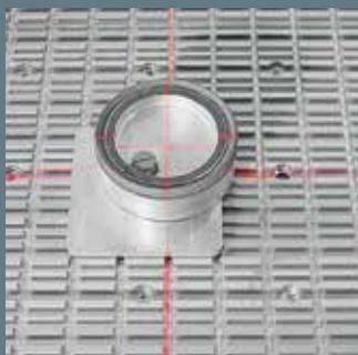
*È possibile configurare il piano di lavoro con innumerevoli tipi di ventose MPS, aggiungendole o rimuovendole agevolmente, in funzione della tipologia e geometria dei pezzi da fissare.*
