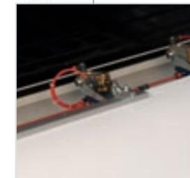
Dispositivo per mantenere in tensione il foglio in PVC.
