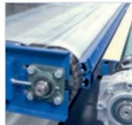
Dispositivo di tensionamento del Mylar semplice e rapido da sostituire.
