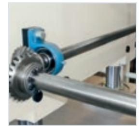
**Piano mobile superiore guidato da coppie di pignoni e cremagliere.** Possibilità di aggiungere il controllo del parallelismo del piano con sistema a parallelogramma. (opz.)
