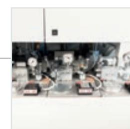
**3 centraline oleodinamiche:** per il controllo indipendente della pressione verticale, di quella orizzontale e del pressoio posteriore.
