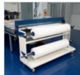
Magazzino dei rotoli PVC con taglio manuale o pneumatico (opz.)
