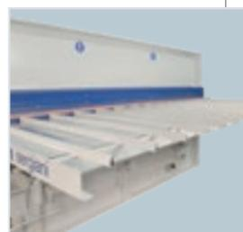
Banco di scarico in profili triangolari in acciaio zincato
