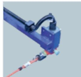
Fune perimetrale di emergenza a normativa CE, posta al di sotto del tappeto di carico e composizione per bloccare la macchina in caso di emergenza. La fune termina su di un microinterruttore con riarmo manuale.
