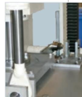
**I cilindri ausiliari per il controllo dell'apertura dei piani** permettono un ciclo rapido e costante.
