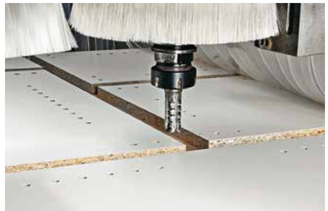
Possibilità di lavorare piccoli pezzi con il pressatore meccanico coassiale.
