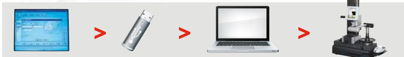
Nel caso di utensili riaffilati occorre misurare le quote nominali, in particolare nuovo diametro minimo e posizione assiale. Per evitare perdite di tempo o dipendere da servizi esterni all'azienda, è possibile tramite il proiettore di profili "Preset Wasp" rilevare le quote utensili e inviarle direttamente al "GT Soft".
