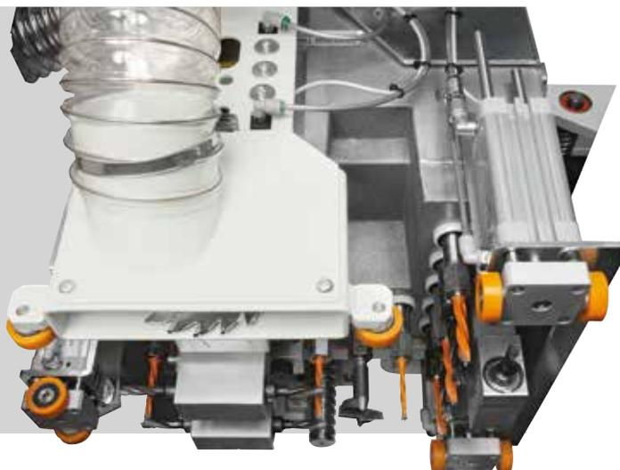
**Cicli di lavorazione molto brevi e zero tempi improduttivi** per le operazioni di set-up; la testa di foratura a 18 mandrini indipendenti (12 verticali, 4 orizzontali lungo l'asse X, 2 orizzontali lungo l'asse Y) e lama in X sull'intera superficie del pannello per lavorare:
