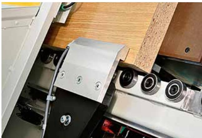
**Massima stabilità del pezzo ed alta qualità di lavorazione,** con la pinza mobile ad apertura flottante che non necessita di alcuna regolazione ed il tavolo antigraffio in bachelite che garantisce alta qualità di lavorazione anche per i pannelli con superfici delicate.
