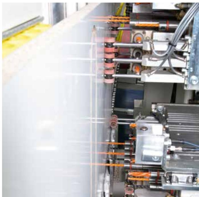
**Fino a 55 mandrini RO.AX** (Rotoaxial spindle technology) montati sulle due teste a forare per eseguire tutte le forature senza necessità di intervento da parte dell'operatore.
