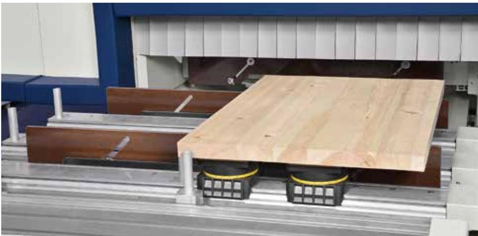
*Posizionamento facile di pezzi pesanti e pannelli di grandi dimensioni con il dispositivo innalzatore.*
