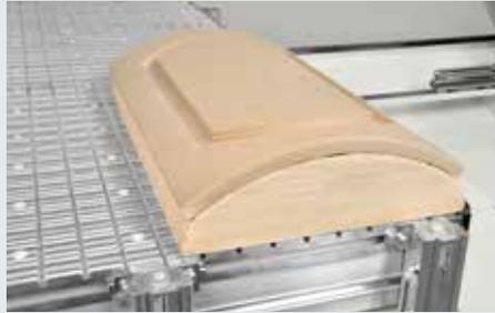
*Facile e veloce posizionamento di accessori di bloccaggio come le ventose MPS e il pratico sistema componibile MODULSET con la struttura a canalizzazioni superficiali.*
