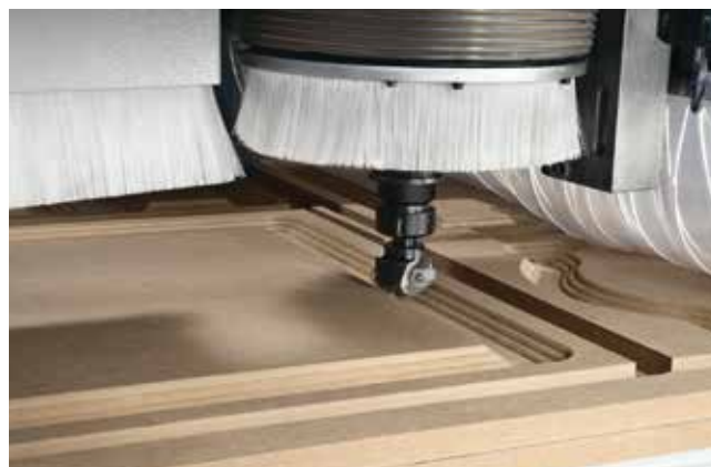
Possibilità di lavorare piccoli pezzi con il pressatore meccanico coassiale.
