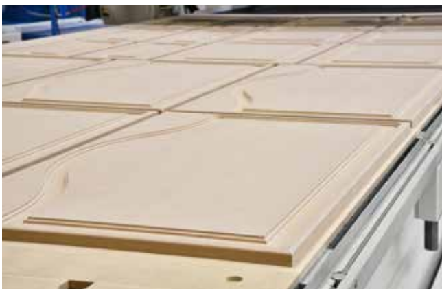
Ottima tenuta del pezzo con il vuoto ad alta portata fino a 1000 m 3 /h.
