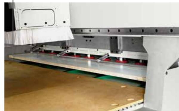
Elevatore di carico in grado di gestire pile di pannelli con altezza fino a 700 mm.
