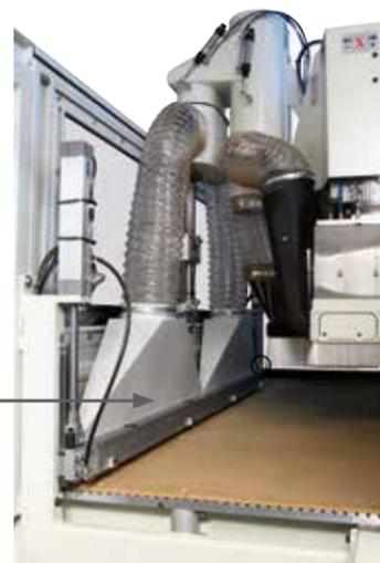
Zero polveri con il sistema di aspirazione superiore per la pulizia del piano di lavoro.
