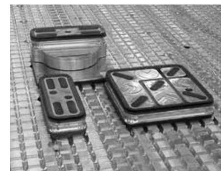
Ampia scelta di ventose MPS e MODULSET per fissare i pezzi sul piano di lavoro a seconda delle lavorazioni da effettuare.
