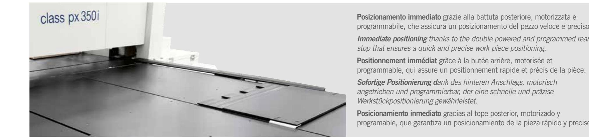
**Posizionamento immediato** grazie alla battuta posteriore, motorizzata e programmabile, che assicura un posizionamento del pezzo veloce e preciso.
