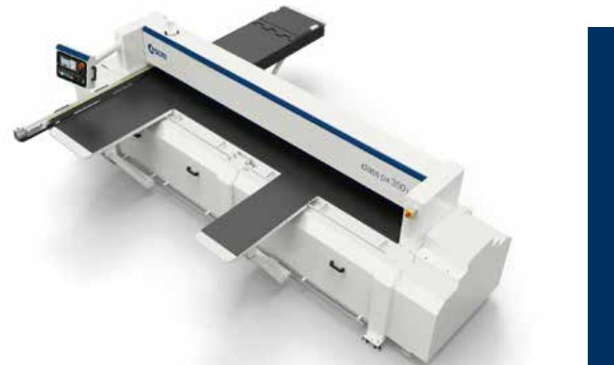
Capacità a quadrare / *Squaring capacity / Capacité à équarrir / Formatschnitte / Capacidad de escuadrado* mm 2600 ÷ 3800
